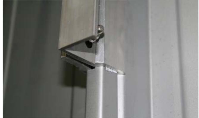
**Bild 17** Falzklemme im Schubversuch
