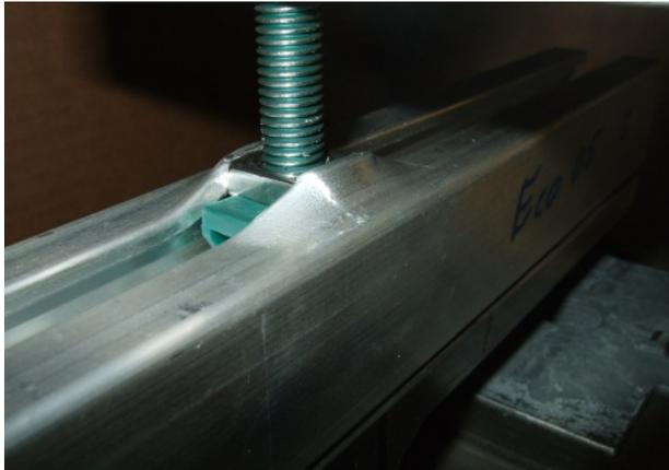
**Bild 5** Versagen des Schraubkanals (Modulklemmen)
